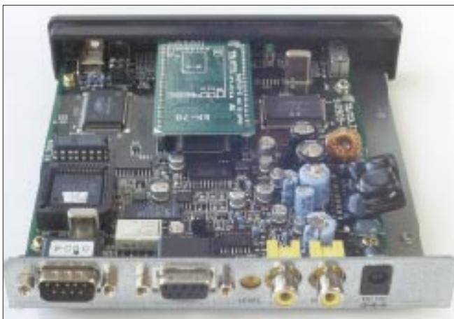
**Bild 3:** Blick in das Gerät. Links sitzt hinter dem Quarz der DSP-IC in einer PLCC-Fassung. Die Leiterplatte für den zweiten Bildspeicher ist über der ersten montiert. Stifteleisten verbinden die Zusatzplatine EM-70 mit dem Motherboard. Rechts ragt der Gleichspannungswandler über den Rand der Hauptleiterplatte.
