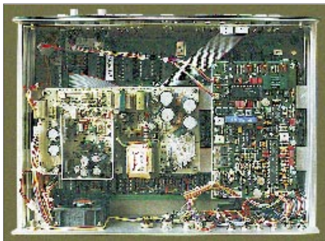
Bild 3: Die vier Leiterplatten des Converters (Lüfter unten links), unten, fast die gesamte Breite und Länge beanspruchend, die Digitalleiterplatte, links oben das Schaltnetzteil, rechts die Analogleiterplatte, oben an der Frontplatte die Tastaturleiterplatte
