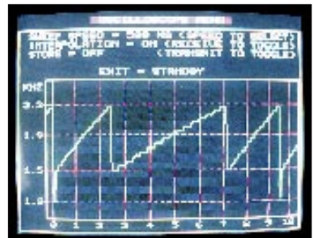
Bild 5: Das Scopemenü des SSTV-Konverters mit einer Bildzeile (Grautreppe) im 120-s-SC-Modus
