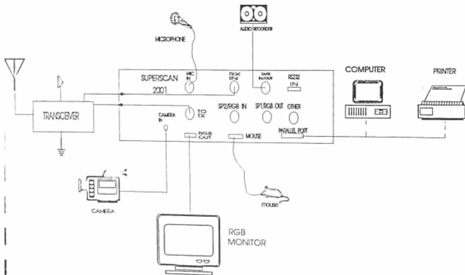
FIG. 1.2 SSTV VIA RADIO LINK
