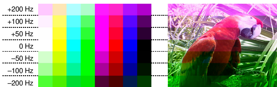
Obrázek 3.9.: Barevné zkreslení YCrCb při nesprávném naladění protistanice.
