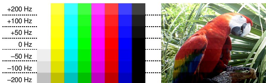
Obrázek 3.10.: Barevné zkreslení RGB při nesprávném naladění protistanice.
