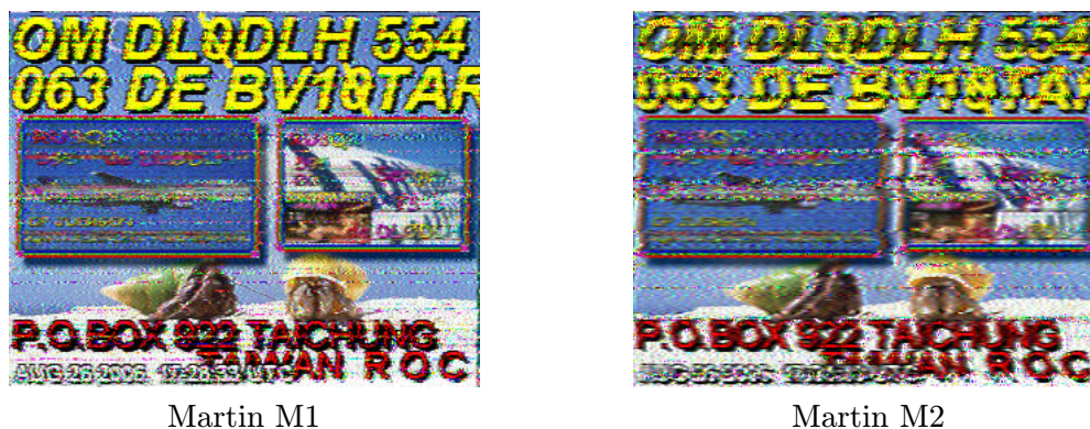
Obrázek 3.4.: Srovnání rozlišení módů Martin v reálných podmínkách pásma 14 MHz.
